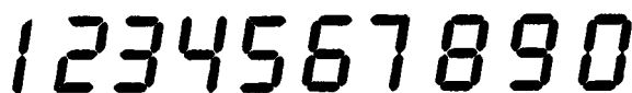
Figura 3: Representación de los nueve dígitos y el cero mediante celdas de siete segmentos.
